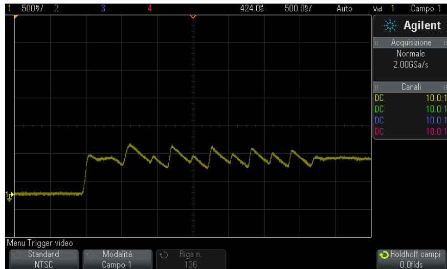
Figura 19 Trigger sul Campo colore 1 alternando con il Campo colore 3
