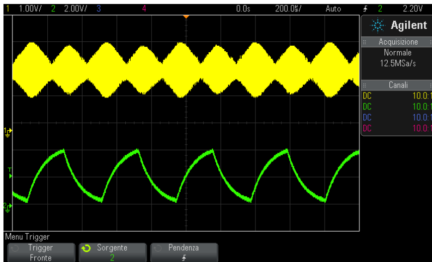
Figura 13 Modulazione dell'ampiezza visualizzata con un'intensità del 100%.
