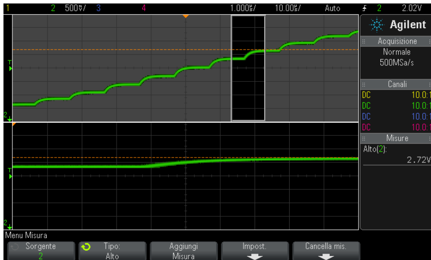
Figura 33 Isolamento di un'area per la misura di Alto
